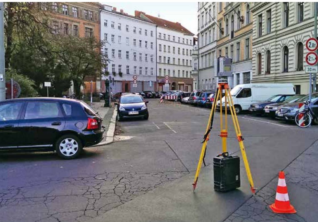
Vermessung umliegender Gebäude am Alfred-Döblin-Platz – im Vordergrund Laserscanner Leica HDS 7000. Foto: Laserscan Berlin
