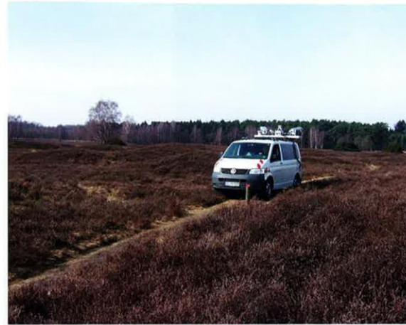
Weiter Blick: Das Messfahrzeug der Firma TopScan aus Rheine mit zwei auf dem Fahrzeugdach montierten Scannern erfasst 500.000 Punkte pro Sekunde bis zu 200 Meter weit. Zusätzlich werden über RGB-Kameras Bilddaten erfasst und mit den Scandaten überlagert. Foto: Denkmal3D / Völker Platen sowie TopScan und Laserscan Berlin.
